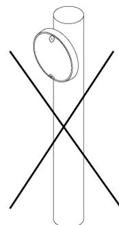
Le luminaire doit être installé sur une surface plane.
