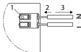
Pour déconnecter les fils, maintenir l'appui sur la languette (1), pousser le fil (2) puis retirer le fil (3)
